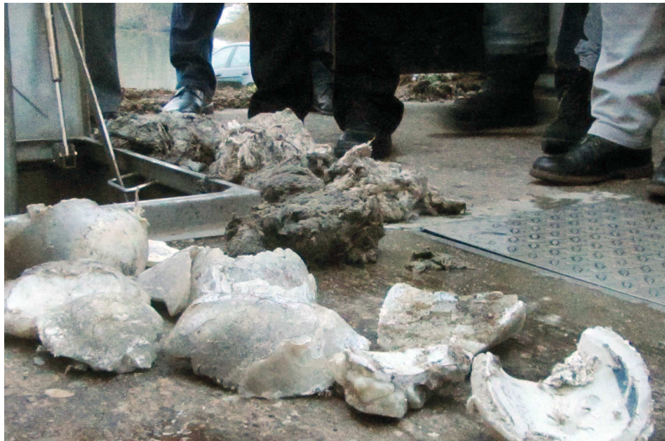
Beweismittel: Von Kanalsanierungsarbeiten stammen die Kunststoffteile im Vordergrund, die Klumpen im Hintergrund waren ursprünglich Toiletten-Feuchtpapier. Weil es sich nicht zersetzt, gehört es nicht in die Toilette. Wenn doch, setzt es Pumpen außer Betrieb. Foto: Tobias Ott
